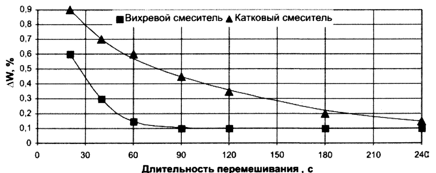
Рис. 1. Влияние типа смесителя и способа перемешивания на равномерность распределения компонентов (воды)
