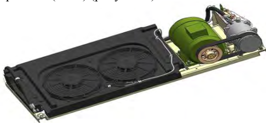
Рисунок 1 - Пример полной трехмерной твердотельной модели компрессорно-конденсаторного агрегата
