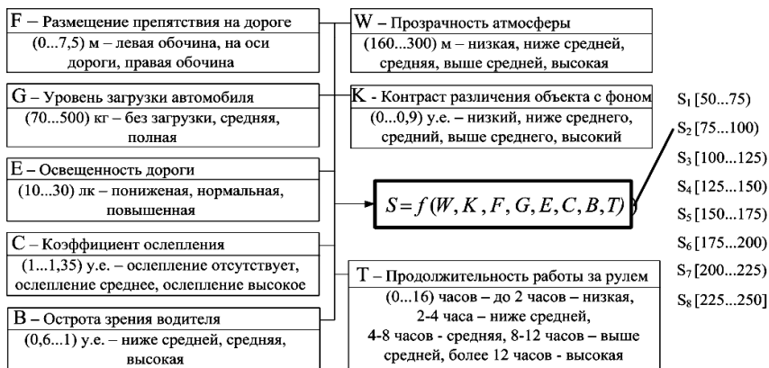
Рис. 1. Структура модели определения дальности видимости S (указаны факторы влияния, универсальное множество и термы для их оценки)
