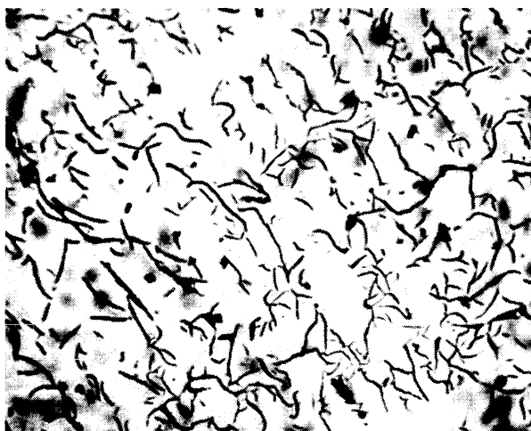
Рис. 2. Микроструктура чугуна, полученного с использованием литейного чугуна марок Л5, Л6: а – до травления; б – после травления. \times 150
