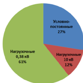
Структура потерь электроэнергии в сетях 0,38-10 кВ РУП "Гомельэнерго"
