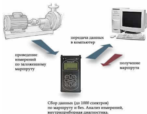
Рисунок 2 - алгоритм работы вибродиагностического комплекса СПЕКТР-07
