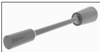
Рис.1. Общий вид внутреннего канала реактора
