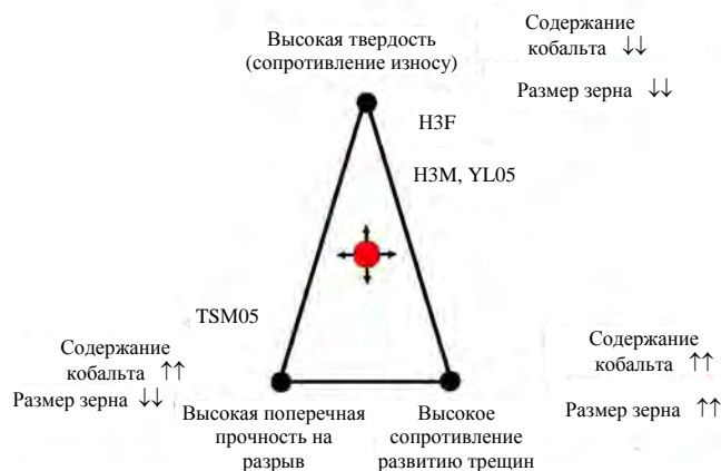
Рис. 6. Зависимость прочности и твердости твердого сплава от размера зерна карбида вольфрама и содержания кобальтовой связки
