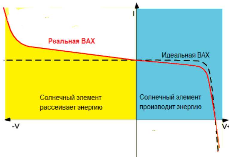
Рисунок 2 - Сравнение идеального и реального солнечных элементов
