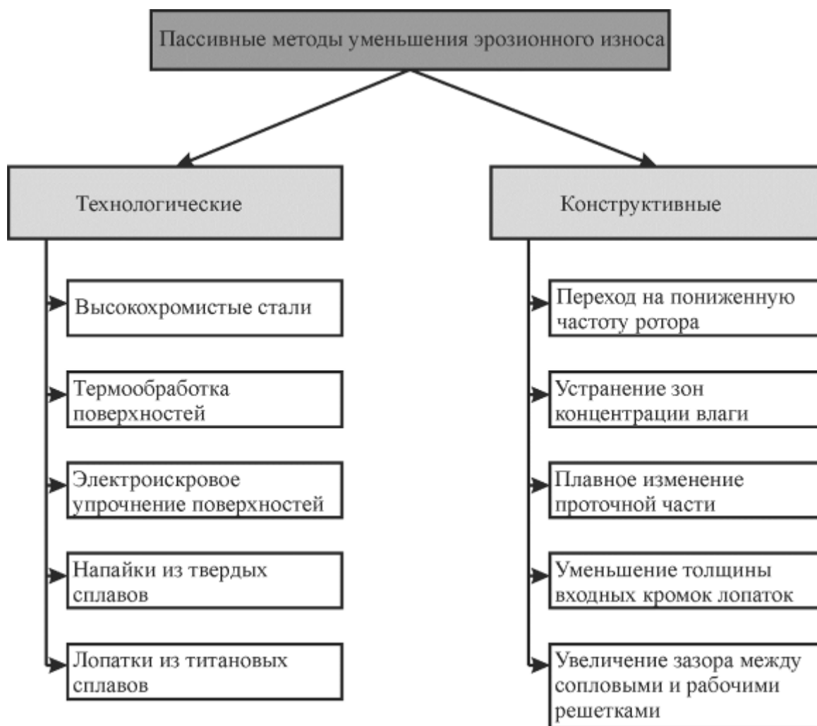
Рисунок 2 – Пассивные методы уменьшения эрозионного износа
