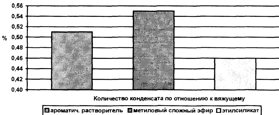
Рис. 17. Склонность к конденсации продуктов пиролиза в зависимости от типа растворителя в Cold-box-вяжущем
