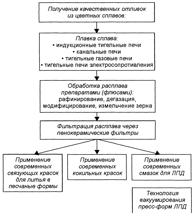
Рис. 1. Общая схема получения качественных отливок из цветных металлов и сплавов
