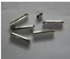
Рисунок 1– Общий вид модификатора на основе олова с добавками наночастиц оксида иттрия
