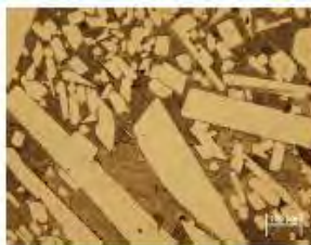
Рисунок 4 – Микроструктура гартцинка, \times 100
