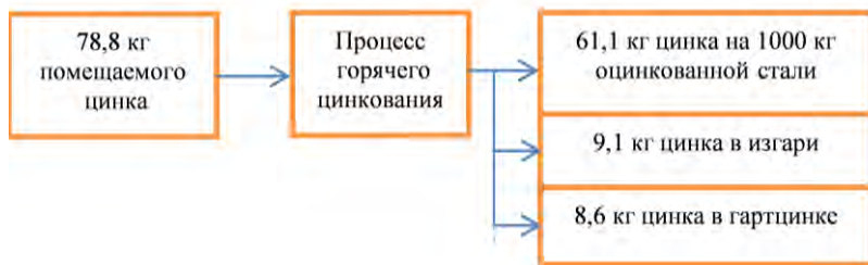
Рисунок 3 – Соотношение масс цинка и отходов в процессе горячего цинкования
