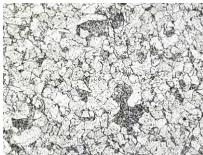
Рисунок 1 – Микроструктура поврежденной зоны, \times 250
