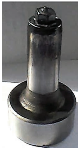
Рис. 3. Общий вид пуансона при окончании эксплуатации: «плыл контур рабочей части»
