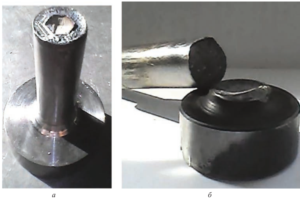
Рис. 13. Пуансоны после завершения эксплуатации: выход из строя по причине отрыва шестигранника (а) или по причине «сломался у основания» (б)
