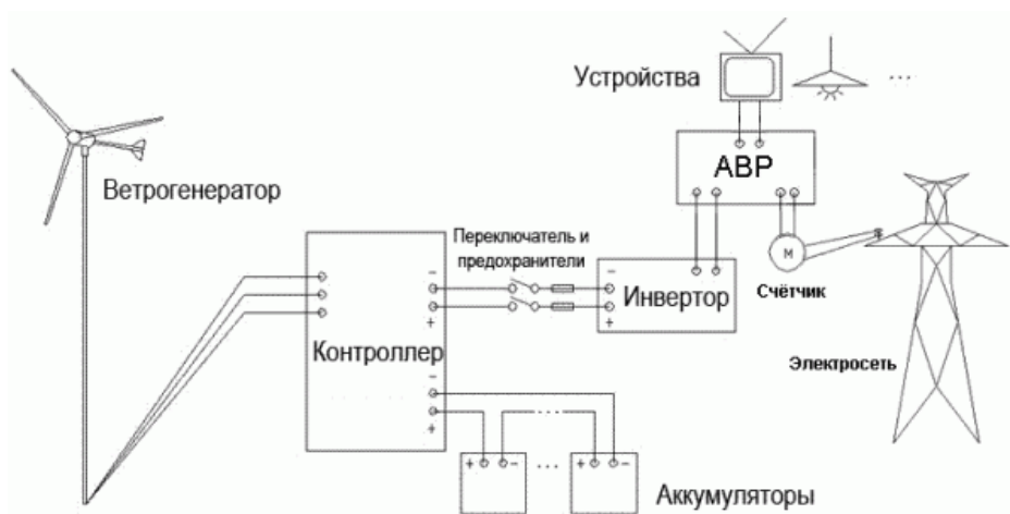
Рисунок 28 – схема работы ветрогенератора с аккумулятором
