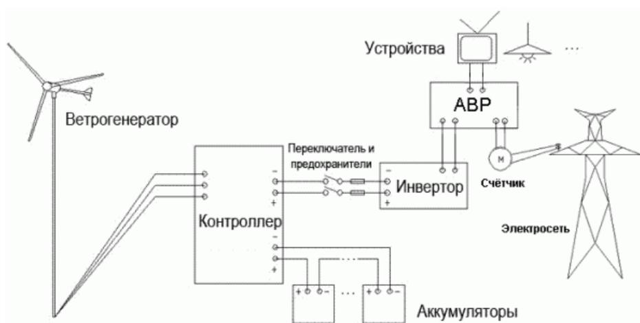
Рисунок 28 – схема работы ветрогенератора с аккумулятором
