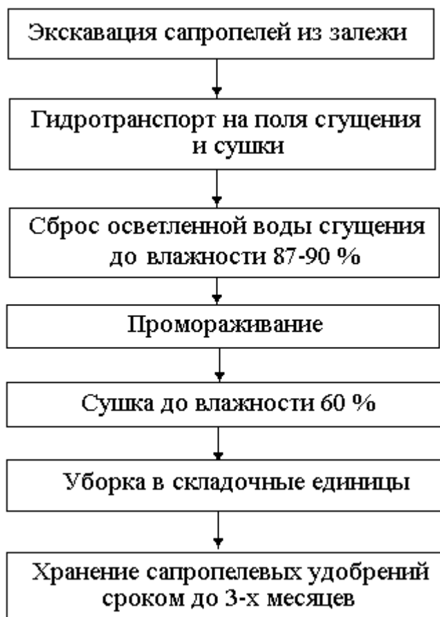
Рис. 2.9. Структурная схема приготовления сапропелевых удобрений
