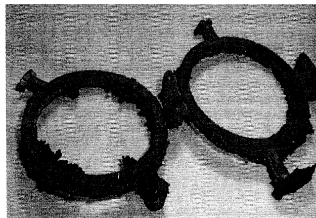
Рис. 6. Дефекты заготовок поршневых колец, связанные с затеканием расплава между формами
