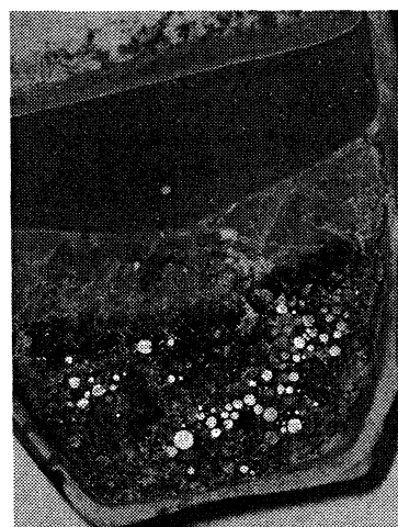
Рис. 2. Корольки металла в продукте статического переплава: алюминиевой стружки под флюсом
