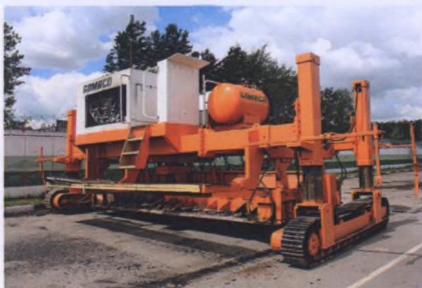
Рисунок 2 – Бетоноукладчик Gomaco GP 2000
