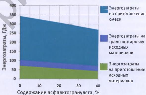
**Рисунок 4 – Структура энергозатрат на строительство 1 км покрытия автомобильной дороги**
