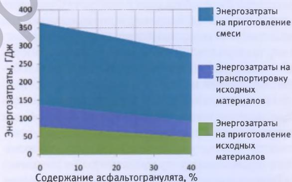
Рисунок 3 – Структура энергозатрат на строительство  $1\text{ км}$  покрытия автомобильной дороги
