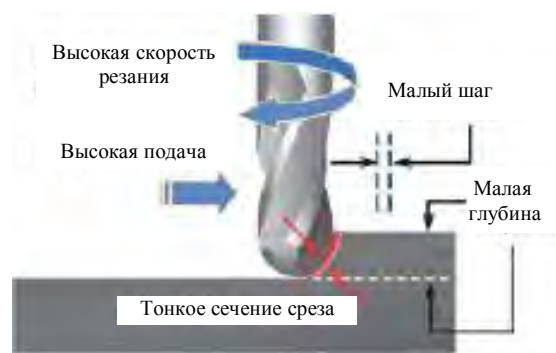
Рис. 2. Параметры резания для высокоскоростной обработки
