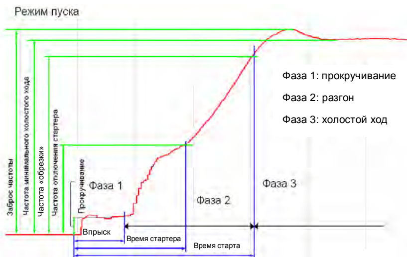
Рис. 1. Фазы режима пуска дизелей с аккумуляторными системами топливоподачи
