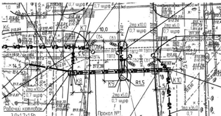
Рисунок 3.37 – План размещения кабельной канализации светофорного объекта
