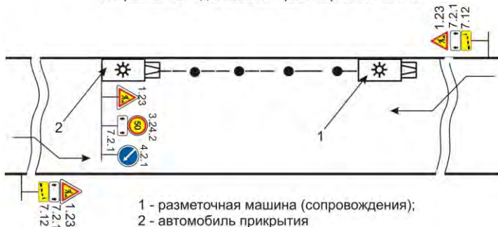
Рисунок 3.31 – Обозначение зоны работ при нанесении линий горизонтальной разметки на проезжей части
