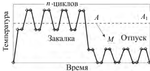
Рис. 2. Диаграмма УТЦО быстрорежущей стали, включающая в себя термоциклирование выше и ниже критической точки A_1 с закалочным охлаждением на последнем цикле и отпуском
