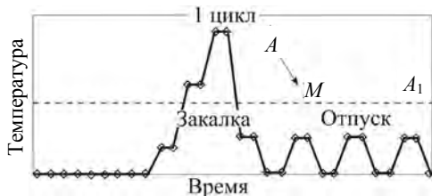
Рис. 1. Диаграмма традиционной термической обработки быстрорежущей стали
