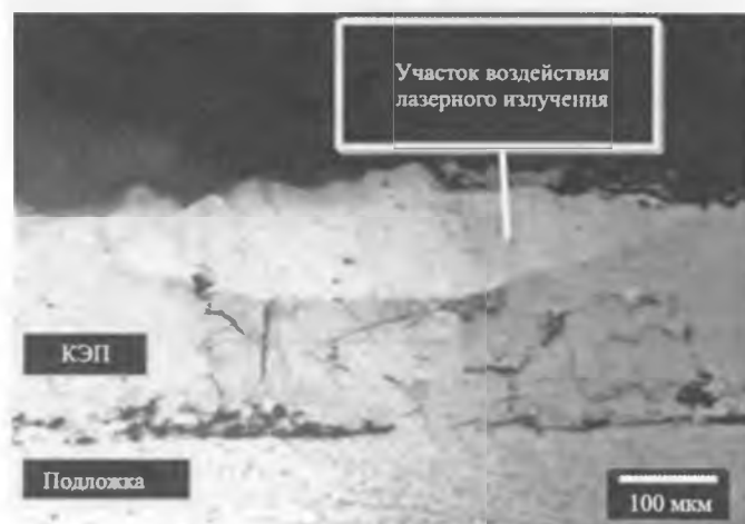
Рис. 8. Микроструктура КЭП Fe — (Ti + C) после лазерной обработки
