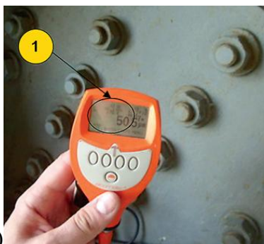
Рисунок 7А – Недостаточная толщина покрытия (1- номинальная толщина грунтовки 80 мкм, фактическая 50,5 мкм), 7Б – Значительное превышение толщины покрытия (1 – номинальная толщина грунтовок 80 мкм, фактическая 781 мкм)
