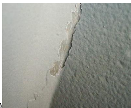
Рисунок 8 - Неудовлетворительная адгезия лакокрасочного покрытия: А – к металлической подложке, Б – к предыдущему слою покрытия
