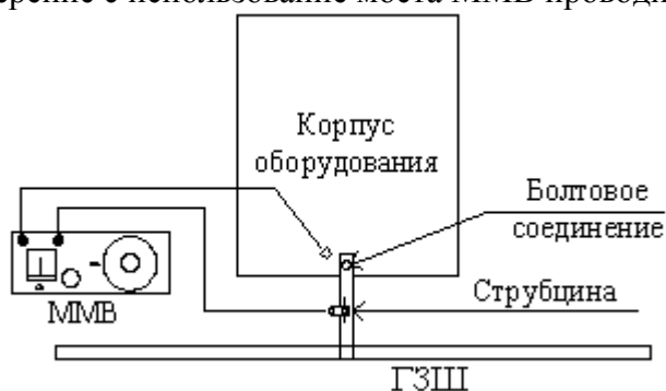
Рисунок 2.48 – Схема измерения металлосвязи с использованием ММВ.
