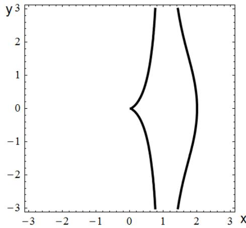
Рис.4.43. Конхоида Никомеда  $(x-a)^2 + (x^2 + y^2) - l^2 x^2 = 0$  (на рис.  $a=l=1$ )
