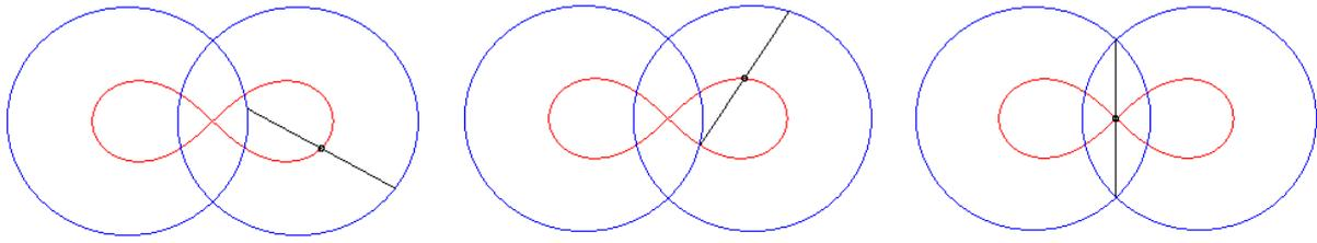
Рис.4.26. Схема построения Лемнискаты Бернулли с помощью одного отрезка
