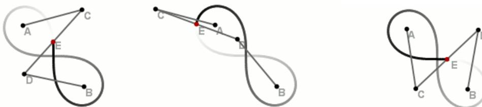
Рис.4.25. Схема построения Лемнискаты Бернулли с помощью трех отрезков
