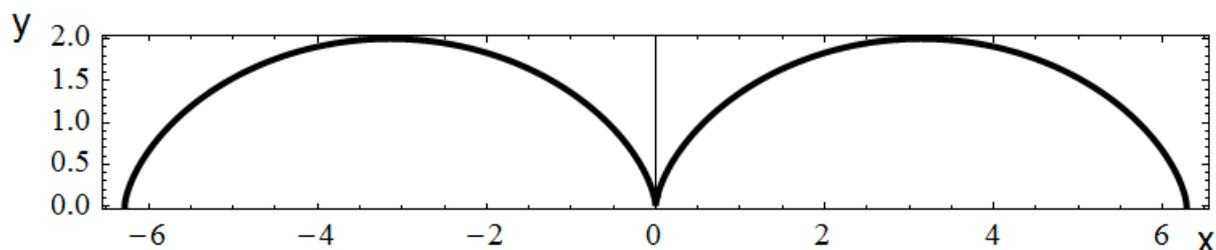
Рис.4.12. Циклоида  $x = a(t - \sin t)$ ,  $y = a(1 - \cos t)$  (на рис.  $a = 1$ )
