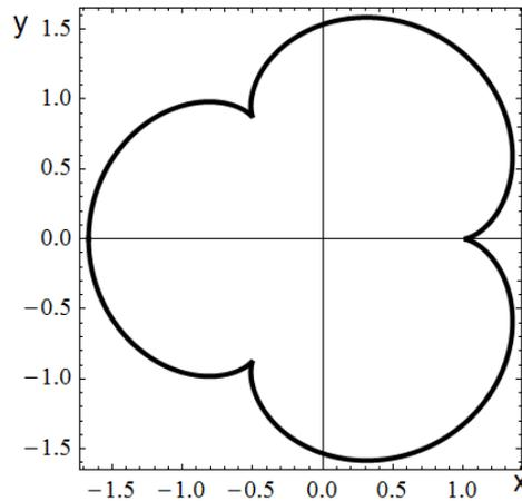
Рис.4.44. Эпициклоида  $x = (A + a)\cos\varphi - a\cos\left(\frac{A+a}{a}\varphi\right)$ ,
