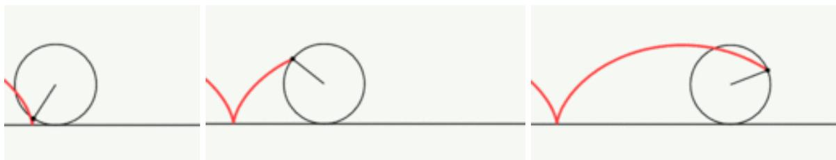
Рис.4.13. Схема построения циклоиды
