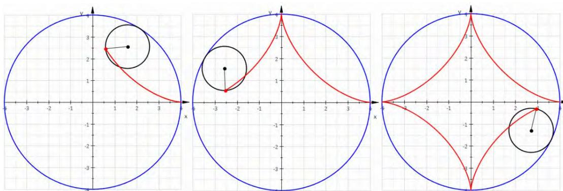
Рис.4.15. Схема построение астроиды
