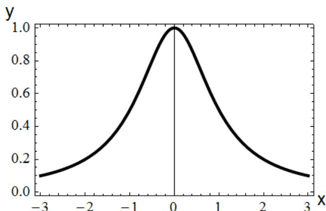
Рис.4.36. Верзиера Аньези  $y = \frac{a^3}{a^2 + x^2}$  (на рис.  $a = 1$ )
