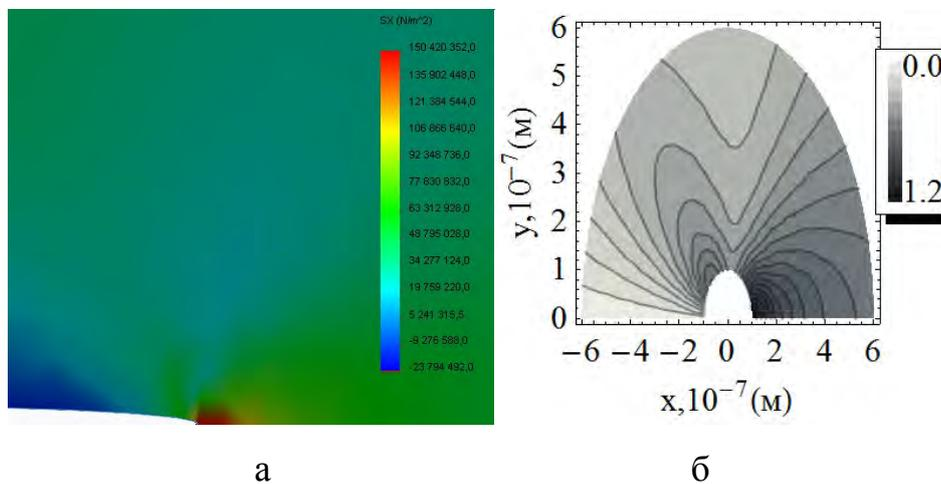
Рис. 5.6. Распределение напряжений  $\sigma_{11}$ , а) полученные методом конечных элементов; б) найденные аналитически методом асимптотических разложений
