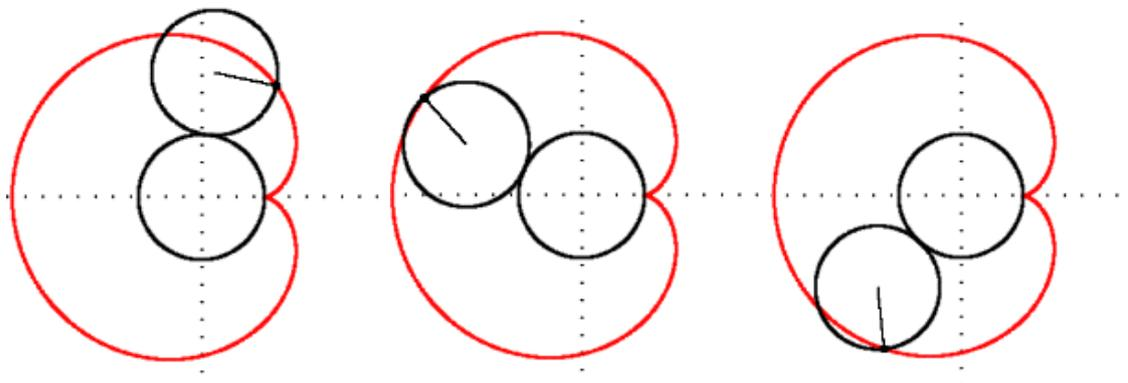
Рис.4.11. Схема построения кардиоиды
