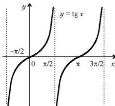
Рис. 3.33. График функции  $y = \operatorname{tg} x$
