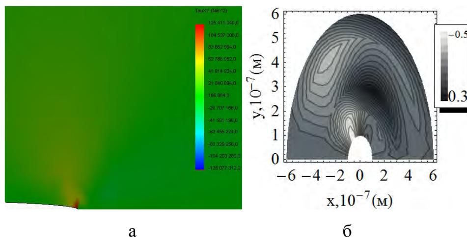
Рис.5.8. Распределение напряжений  $\sigma_{12}$ , а) полученные методом конечных элементов;
