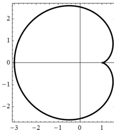
Рис.4.10. График кардиоиды в полярной системе координат для случая, когда  $a = 1$
