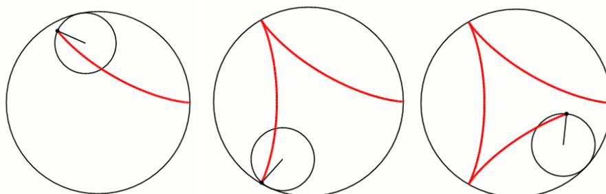
Рис.4.48. Схема построения гипоциклоиды
