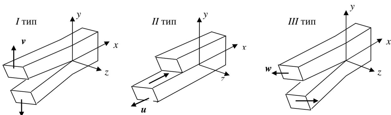
Рис.5.1. Три основных типа трещины
