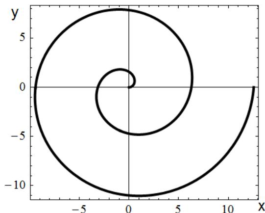
Рис.4.16. Спираль Архимеда  $\rho = a\varphi$  (на рис.  $a = 1$ ;  $\varphi \in [0, 4\pi]$ )
