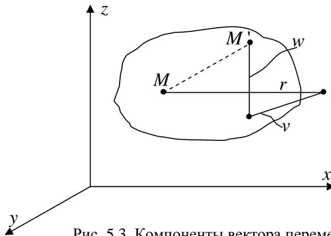
Рис. 5.3. Компоненты вектора перемещений
