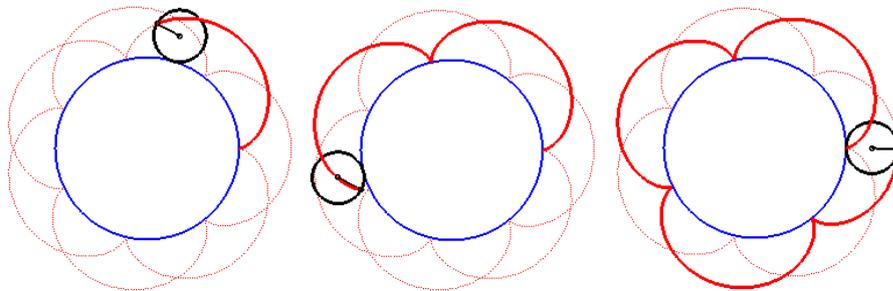
Рис.4.45. Схема построения эпициклоиды
