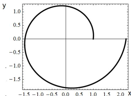
Рис.4.19. Логарифмическая спираль  $\rho = e^{a\varphi}$  (на рис.  $a = 1/8$ )
