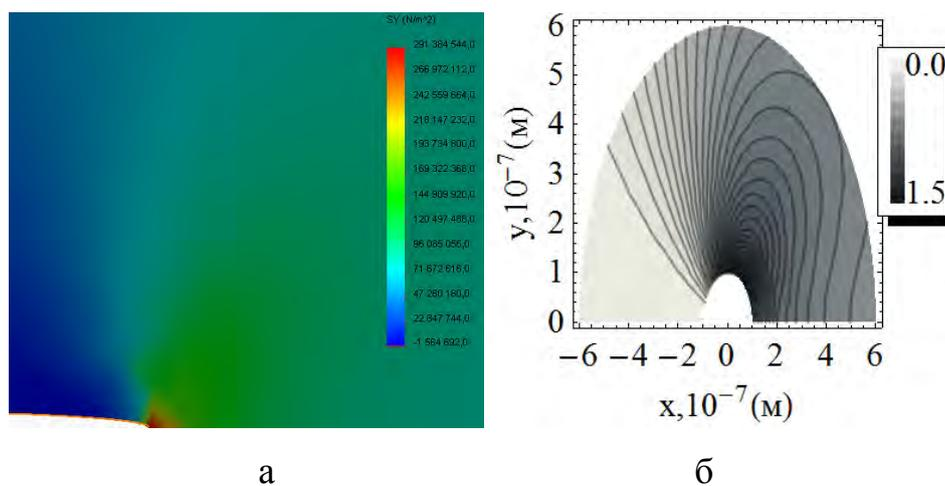
Рис.5.7. Распределение напряжений  $\sigma_{22}$ , а) полученные методом конечных элементов; б) найденные методом асимптотических разложений
