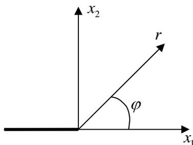
Рис. 5.4. Система координат, берущая начало в вершине трещины
