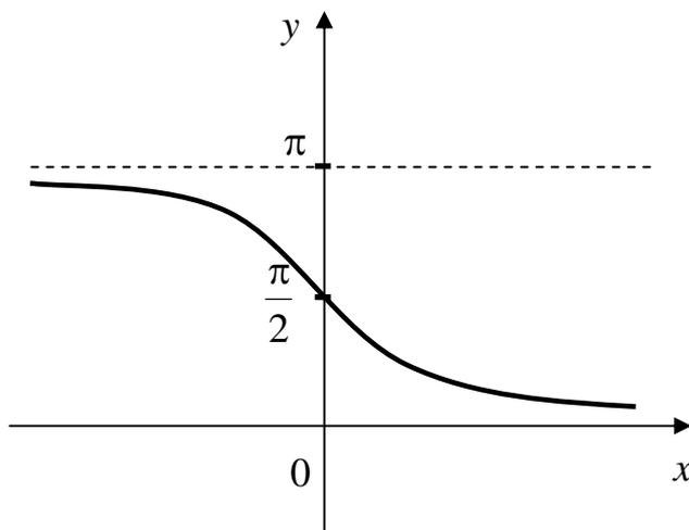
Рис. 3.38. График функции  $y = \operatorname{arcsctg} x$
