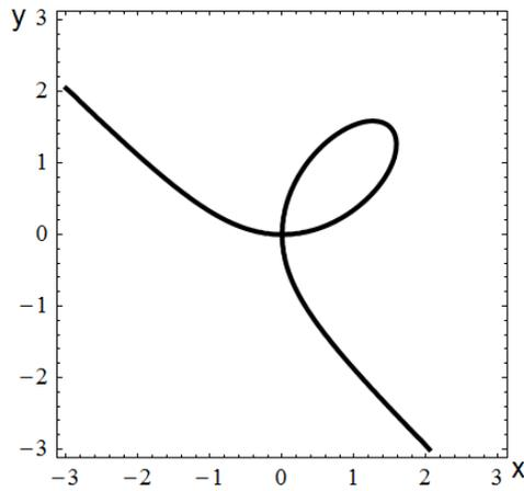
Рис.4.31. Декартов лист  $x^3 + y^3 - 3axy = 0$  (на рис.  $a = 1$ )
