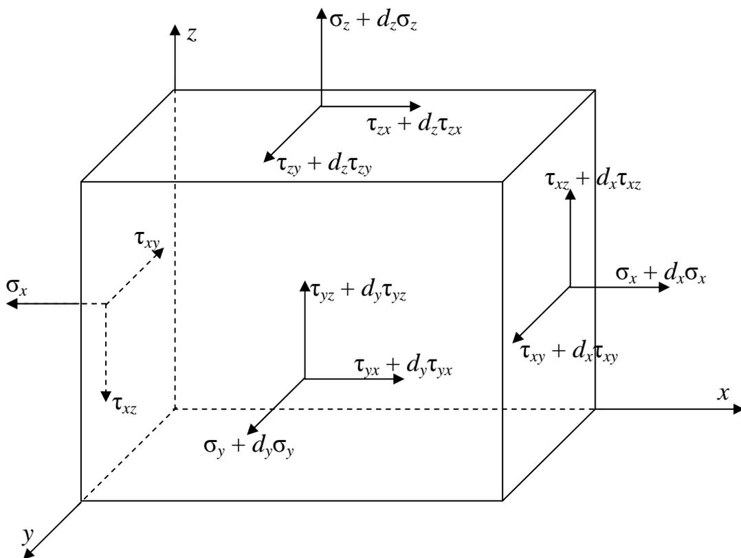
Рис.5.2. Равновесие элементарного параллелепипеда
