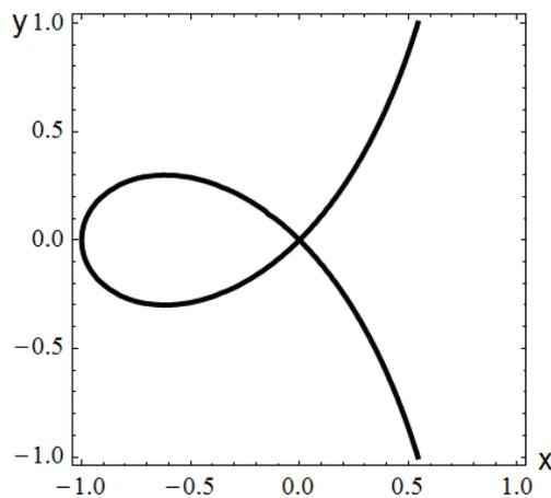
Рис.4.35. Строфоида  $y^2 = x^2 \left( \frac{a+x}{a-x} \right)$  (на рис.  $a=1$ )
