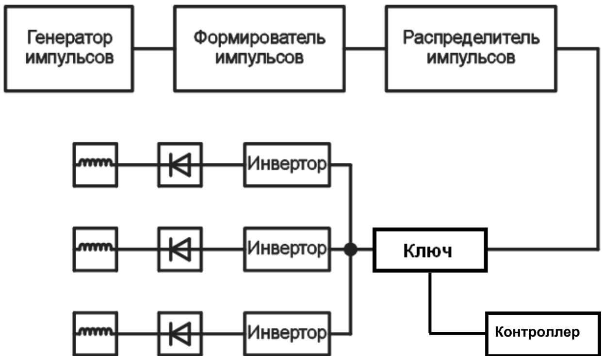
Рис. 16.3 – Функциональная схема управления шаговым двигателем
