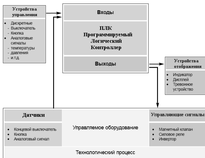
Рис. 1.1. Функциональная схема СУ на базе ПЛК
