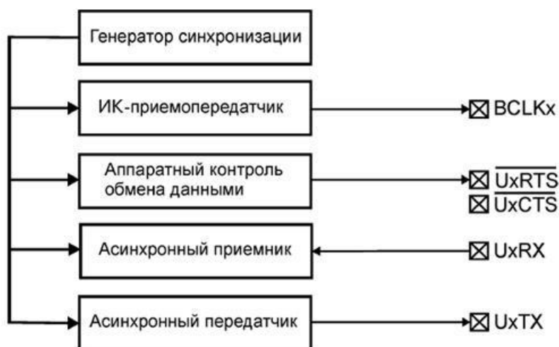
Рис. 1.1. Упрощенная схема модуля асинхронного обмена данными
