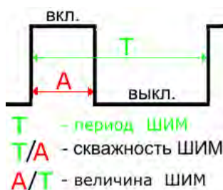
Рис. 1. Схема ШИМ сигнала
