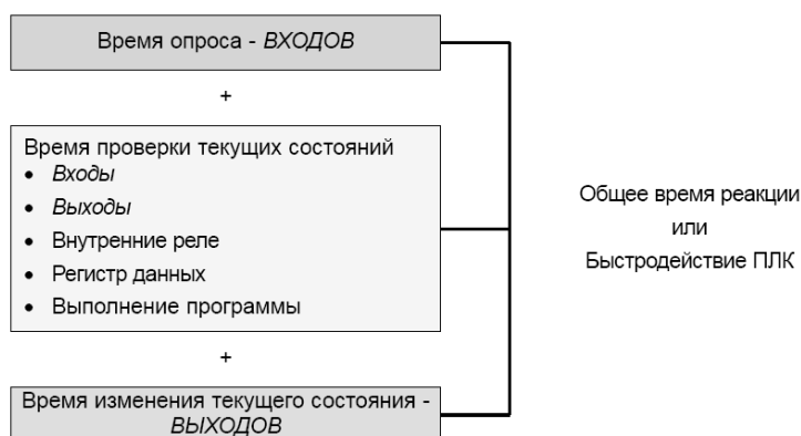
Рис. 1.4. Время реакции или быстродействие ПЛК
