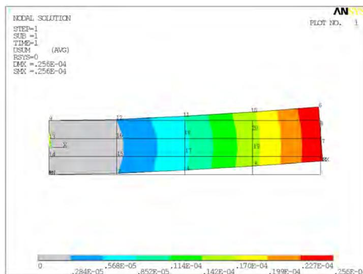
Рис 2. Деформированное состояние пластины
