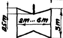
Компрессор газотурбинной установки (высокого, среднего, низкого давления), турбокомпрессор, трубовоздуховка
