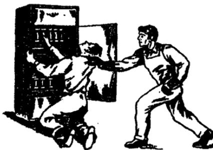
Рис. 11.4. Отделение пострадавшего от токоведущей части, находящейся под напряжением до 1000 В
