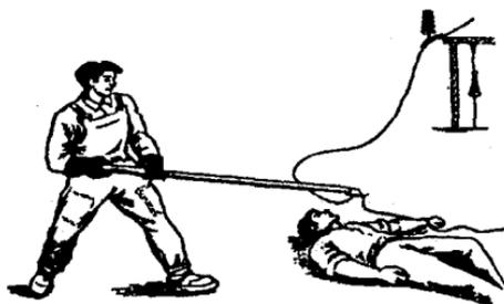
Рис. 11.6. Освобождение пострадавшего от тока в установках свыше 1000 В отбрасыванием провода изолирующей штангой
