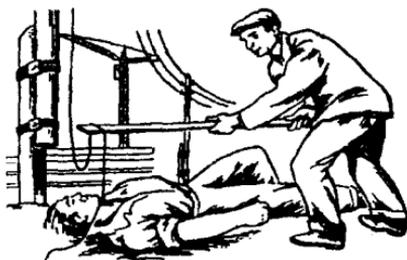
Рис. 11.2. Освобождение пострадавшего от тока в установках до 1000 В отбрасыванием провода доской
