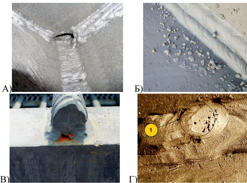
Рисунок 4А – Неровный профиль сварного шва, 4Б – Сварочные брызги,
