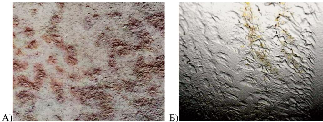
Рисунок 3А – Язвы (питтинг) и кратеры на стальной поверхности,
