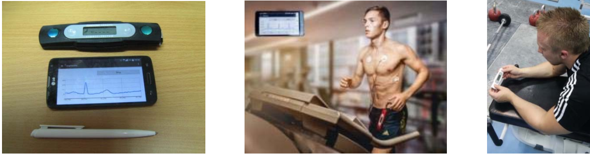
Рисунок 2 – Кардиотестер «Сателлит» и его применение в нагрузочном тесте (связь со смартфоном осуществляется по каналу Bluetooth)
