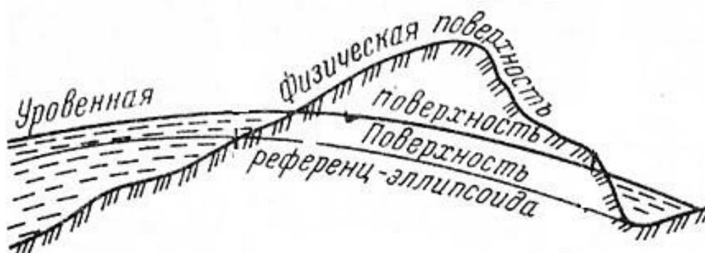
Рис. 1- Физическая и уровенная поверхности Земли
