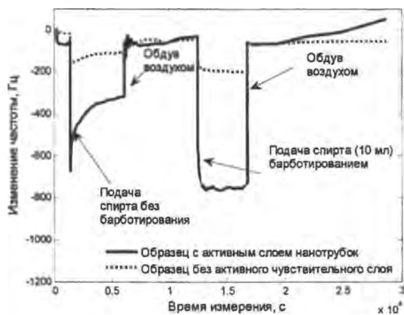
Рис. 8. Реакция чувствительного элемента акустоэлектронного сенсора на воздействие паров спирта
