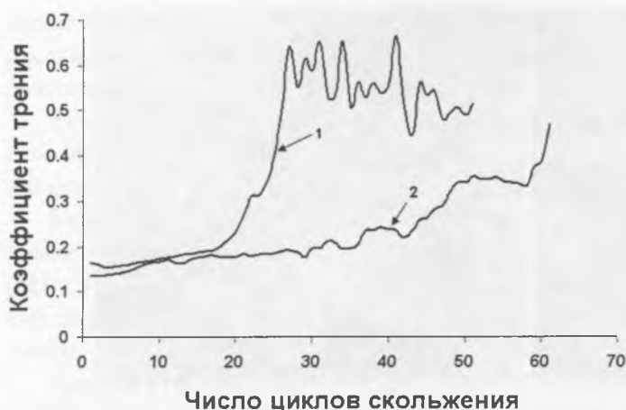
Рис. 3. Зависимость коэффициента трения от числа циклов скольжения для покрытия, полученного на стали из композита \text{SiO}_2 -ПВС и модифицированного ОТС: 1 – необработанная сталь, 2 – 1\text{SiO}_2 : 1\text{PVC/OTS}
