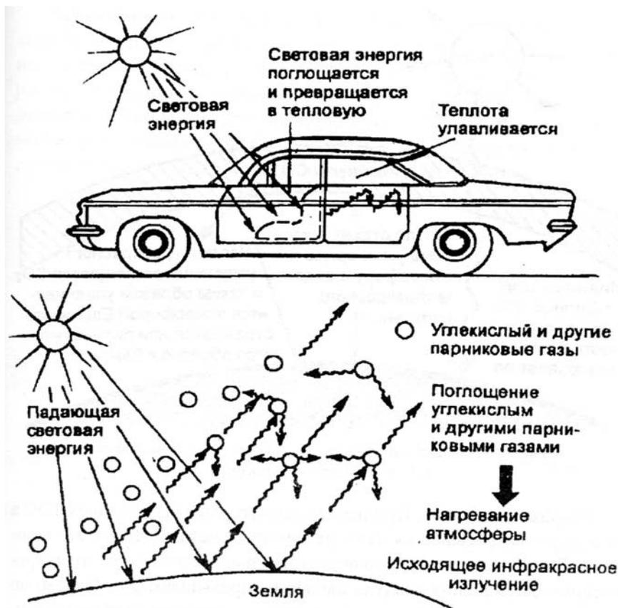
Рис. 2.8. Схема возникновения парникового эффекта. Аналогично автомобилю или парнику нагревается атмосфера Земли: свет сквозь нее проникает, а инфракрасное излучение поглощается парниковыми газами. Чем выше концентрация этих газов, тем сильнее нагревается атмосфера
