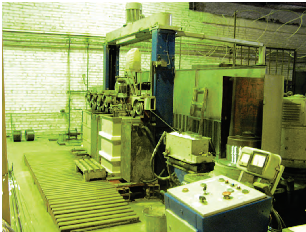
Рис. 2. Малогабаритная установка скоростного гальванического цинкования проволоки
