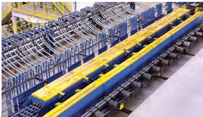
Рис. 9. Установка ускоренной термической обработки прутков
