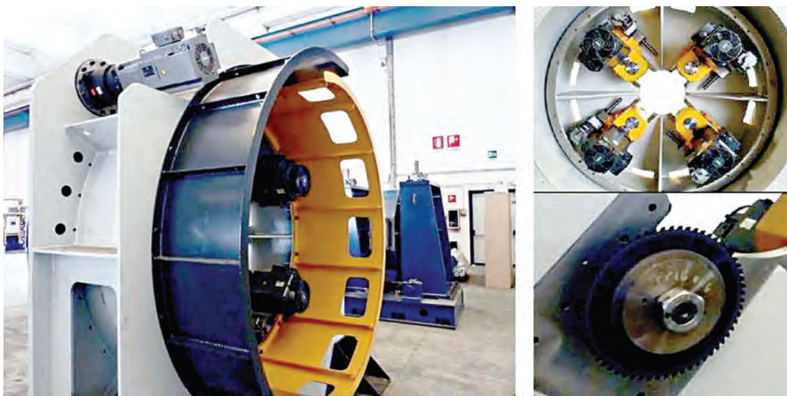
Рис. 3. Машина для резки трубы на кольцевую заготовку
