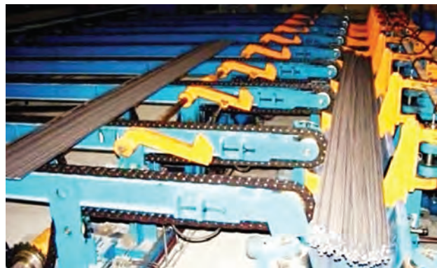
Рис. 10. Воздушный холодильник с карманом для обвязки пакета проката
