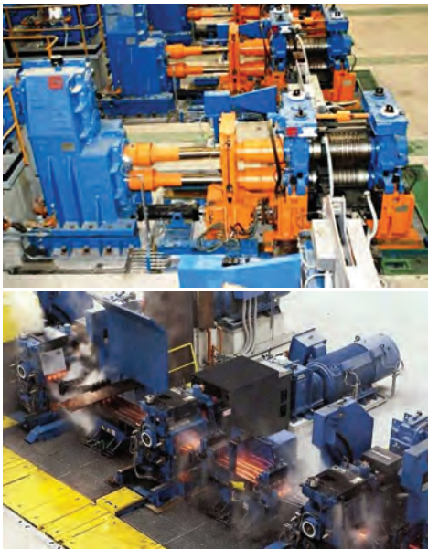
Рис. 6. Непрерывная группа клетей и чистовая клеть многониточной прокатки
