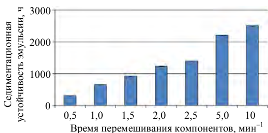
Рис. 5. Влияние времени перемешивания компонентов на седиментационную устойчивость эмульсии при скорости перемешивания 3000 мин -1 (температура подогрева исходных компонентов составляет 70 °С)
