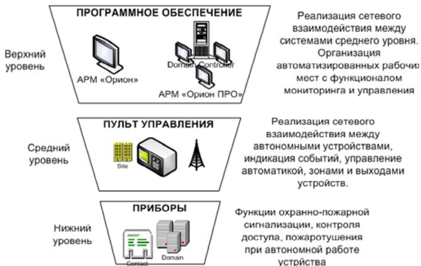
Рисунок 1 – Трехуровневая модель системы «Орион»
