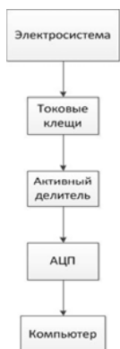
Рисунок 1 – структурная схема арбитражного бортового даталоггера - возможность запуска программ
