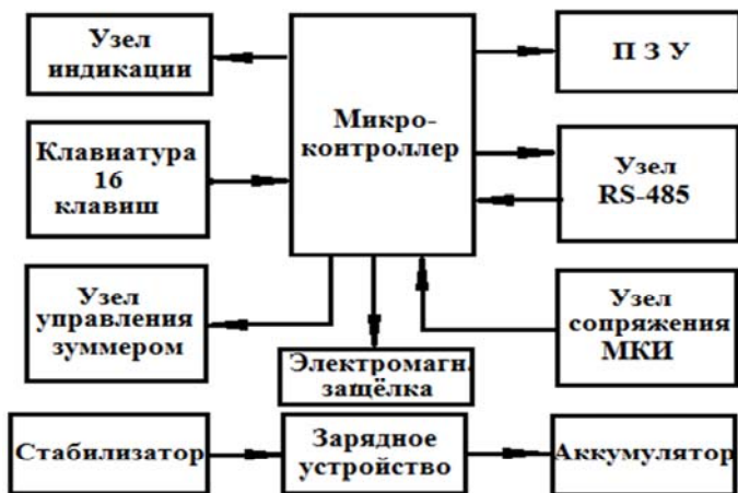
Рисунок 1. Структурная схема адресного автономного устройства ввода данных и паролей
