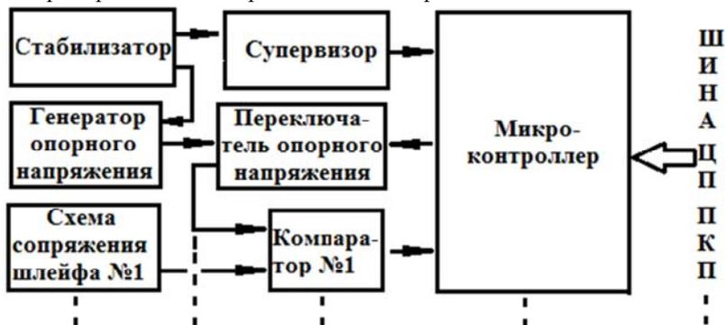
Рисунок 1. Структурная схема модуля контроля шлейфов ПКП ОС.
