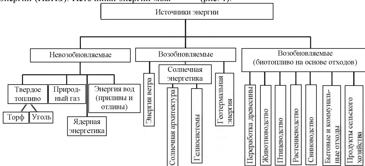
Рис. 1. Структурная схема подразделения энергетических ресурсов
