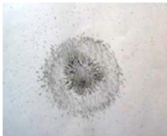
Находясь в раскрученном состоянии, магнитный волчок способен зависнуть над системой постоянных магнитов (система магнитного подвеса). Магнитный волчок представляет собой кольцевой постоянный магнит с вертикальной осью вращения, проходящей через его центр симметрии. На рисунке приведена фотография, иллюстрирующая магнитное поле
