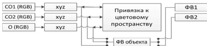
Рисунок 1 – Общая схема функционирования приложения «Экситон»
