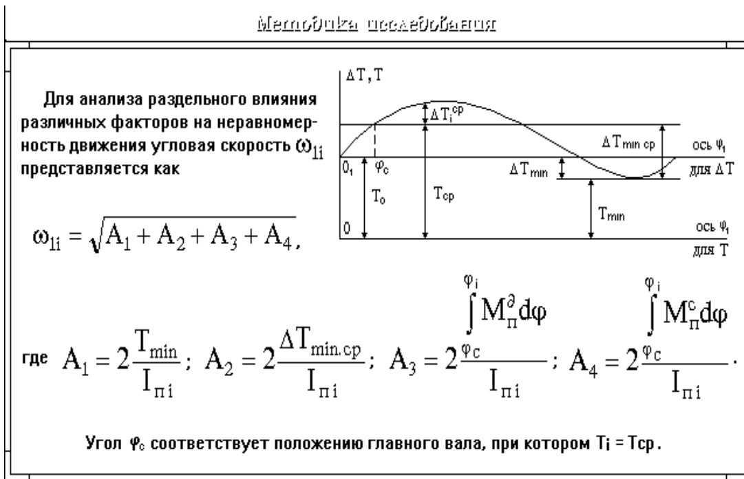
Рис. 1. График функции T = T(\varphi_1) кинетической энергии машины от угла \varphi_1 поворота главного приводного вала машины.
